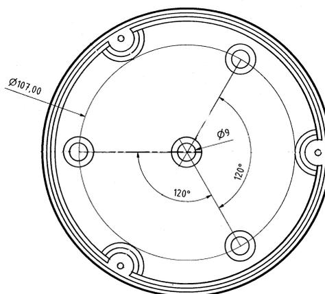
*Kabeleinführung und Befestigungslöcher*
